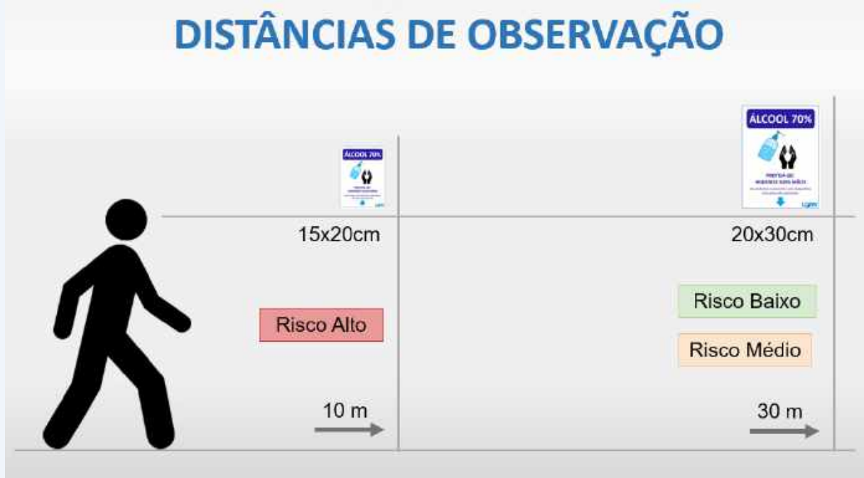
Figura 1 - Distância de observação de sinalização de equipamentos de higienização.
